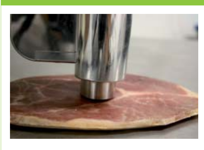
Figura 4. Lecturas con Sequid RFQ Scan sobre una loncha de jamón curado
